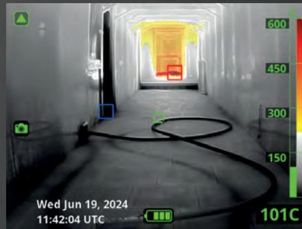
Markiert automatisch die heißeste bzw. kälteste Stelle einer Szene mit Hilfe eines roten bzw. blauen Quadrates.
