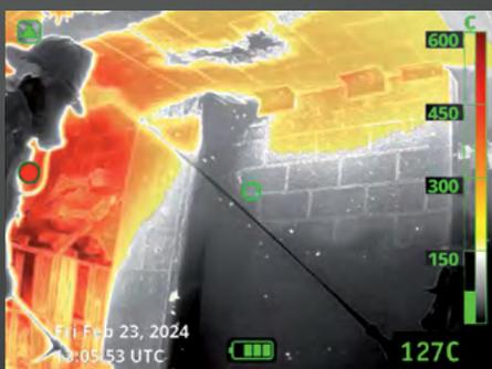
Das Farbschema ist intuitiv zu verstehen. Die transparente Einfärbung beginnt ab 260 °C und warnt visuell, wenn sich die Temperaturen einem Bereich nähern, der die persönliche Schutzausrüstung beschädigen kann.
