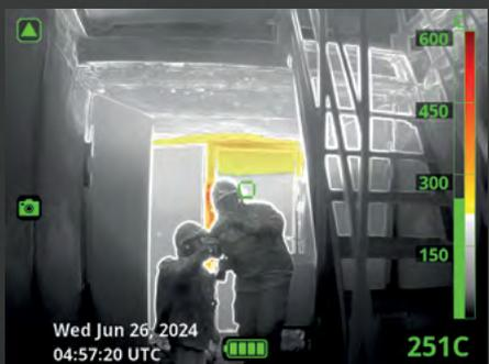
Das automatische Umschalten zwischen Hoch- und Niedrig-Empfindlichkeitsmodus läuft ohne Unterbrechnung ab.
